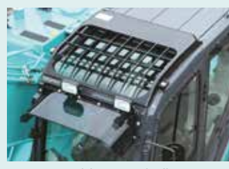
La protezione del tettuccio (livello II) è una dotazione standard.
