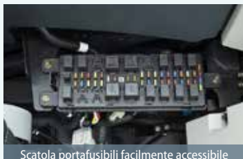
Scatola portafusibili facilmente accessibile
