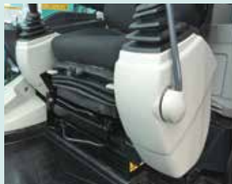
Le sospensioni del sedile assorbono le vibrazioni
