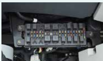
Scatola portafusibili facilmente accessibile
