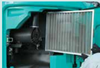
Filtro iNDR/serbatoio di riserva radiatore/filtro dell'aria
