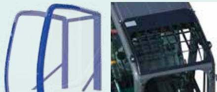
Protezione sul tettuccio di livello II (conforme a ISO10262)
