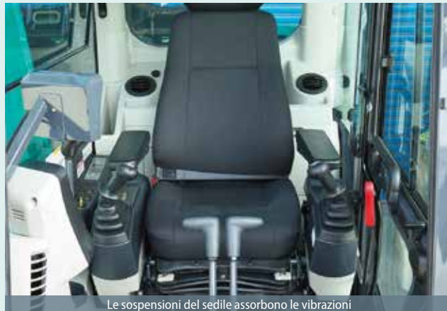
Le sospensioni del sedile assorbono le vibrazioni
